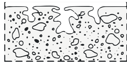
Разрез поверхности без покрытия
